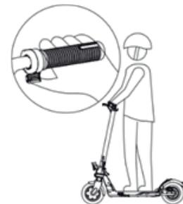
2. Cuando el scooter alcance determinada velocidad, suba su otro pie. Cuando sienta sus pies estables, presione el acelerador.
